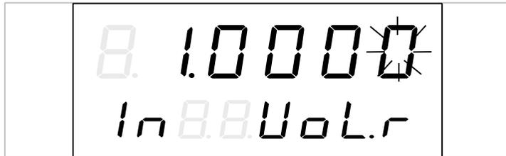
Input 'Voltage Ratio' [Vol.r]: 1.0000~2.0000.
